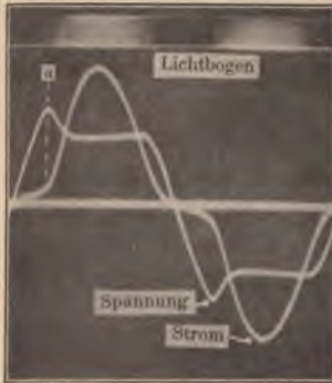
Abb. 369. Oszillographische Aufnahme von Strom, Spannung und Lichtbogen eines Wechselstromlichtbogens zwischen Kohlen.
